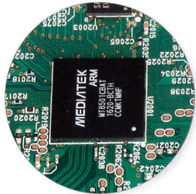
Il gruppo mobile di lettura è sostenuto da una piattaforma in plastica molto robusta per consentire un movimento preciso e geometricamente perfetto nel sollevamento e nella presa del disco ottico. L'elettronica, collocata in basso, impiega un SoC Mediatek MT8501 (qui sopra a sinistra).
