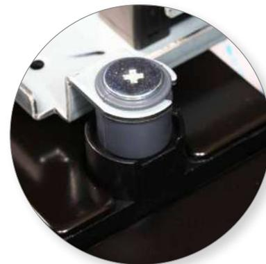
Il gruppo ottico è isolato dalla base con quattro inserti in gomma butilica espressamente realizzati per lo spostamento del picco di risonanza del sistema di lettura sia sul piano orizzontale che su quello verticale.
