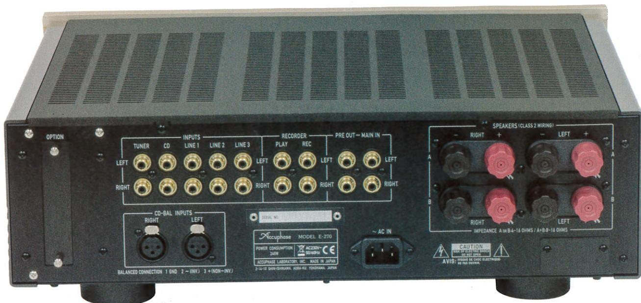
La dotazione di ingressi e uscite è notevole. 1 ingresso bilanciato, 5 ingressi sbilanciati, ingressi e uscite recorder (utili anche per l'impiego di processori di segnale). Si possono collegare due coppie di diffusori o sfruttare il bi-wiring grazie alla doppia coppia di boccole. La qualità dei connettori è notevole. A sinistra si nota lo sportellino rimovibile che copre l'alloggiamento delle schede opzionali.
