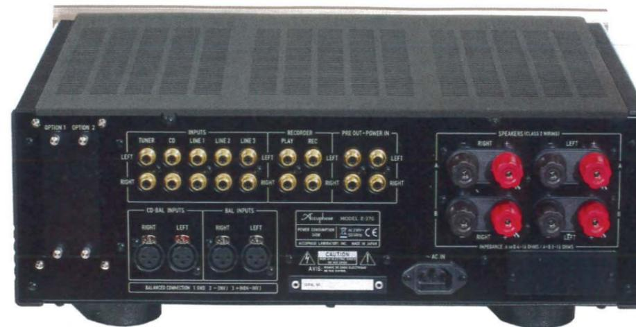
Le connessioni di segnale sono concentrate nella parte centrale dell'apparecchio, con una disposizione ergonomica e comoda da raggiungere. I connettori XLR sono posti in basso e non sono di intralcio alle altre connessioni RCA, più snelle e flessibili. I morsetti di potenza con doppia connessione per due coppie di diffusori o per collegamenti in bi-wiring sono poste al lato destro dell'apparecchio in posizione molto ravvicinata anche se al sicuro da cortocircuito.
