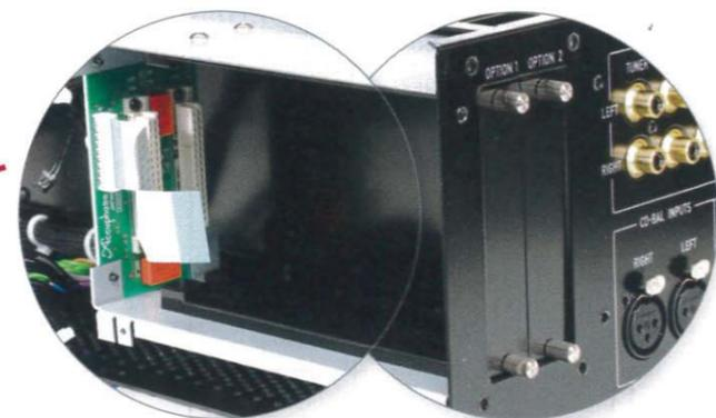
Lo slot per le due schede opzionali impiega due connettori multipolari per la connessione di un DAC, un pre fono o in alternativa un ulteriore ingresso linea.
