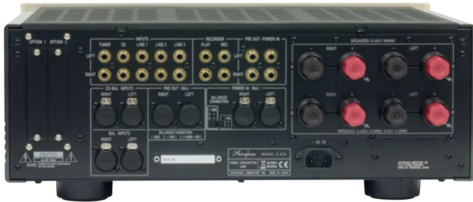
La dotazione di ingressi ed uscite di linea è analoga a quella già molto ampia dei predecessori, ma aggiunge la duplicazione bilanciata per le uscite della sezione preamplificatore e gli ingressi di quella finale di potenza. I morsetti sono di fattura eccellente, comodi, affidabili e protetti da contatti accidentali. Tutta la struttura meccanica, oltre che solida, è particolarmente inerte rispetto alle sollecitazioni esterne.
