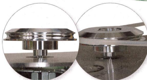
La puleggia del motore ha la sede circolare dello stesso diametro della sezione della cinghia di trasmissione che è di colore bianco traslucido. L'asse del motore è molto sottile ma gira senza oscillazioni evidenti.
