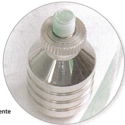
I piedi si avvitano direttamente nel metacrilato in una sede filettata che consente la regolazione dell'altezza che, una volta regolata, si fissa tramite la controgliera.
