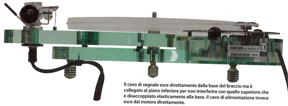
Il cavo di segnale esce direttamente dalla base del braccio ma è collegato al piano inferiore per non interferire con quello superiore che è disaccoppiato elasticamente alla base. Il cavo di alimentazione invece esce dal motore direttamente.
