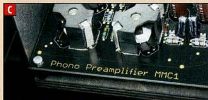
riguarda l'impedenza di carico, per il quale il costruttore ha previsto un valore compreso tra i 40 e i 400 Ohm. Mentre se la testina MC ha una tensione d'uscita piuttosto elevata e quindi il guadagno all'ingresso MC risulta troppo alto, col rischio di portare in saturazione l'uscita e mettere in crisi il preamplificatore, bisognerà utilizzare l'ingresso MM con l'avvertenza di dover utilizzare delle impedenze esterne per il giusto abbinamento.
